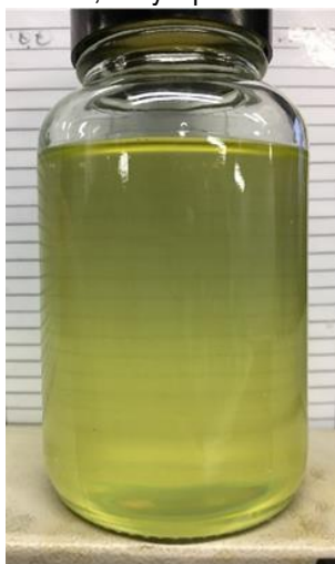
HYPERLAST™ LE 153 FC Prepolymer Amber, hazy liquid at 25°C
